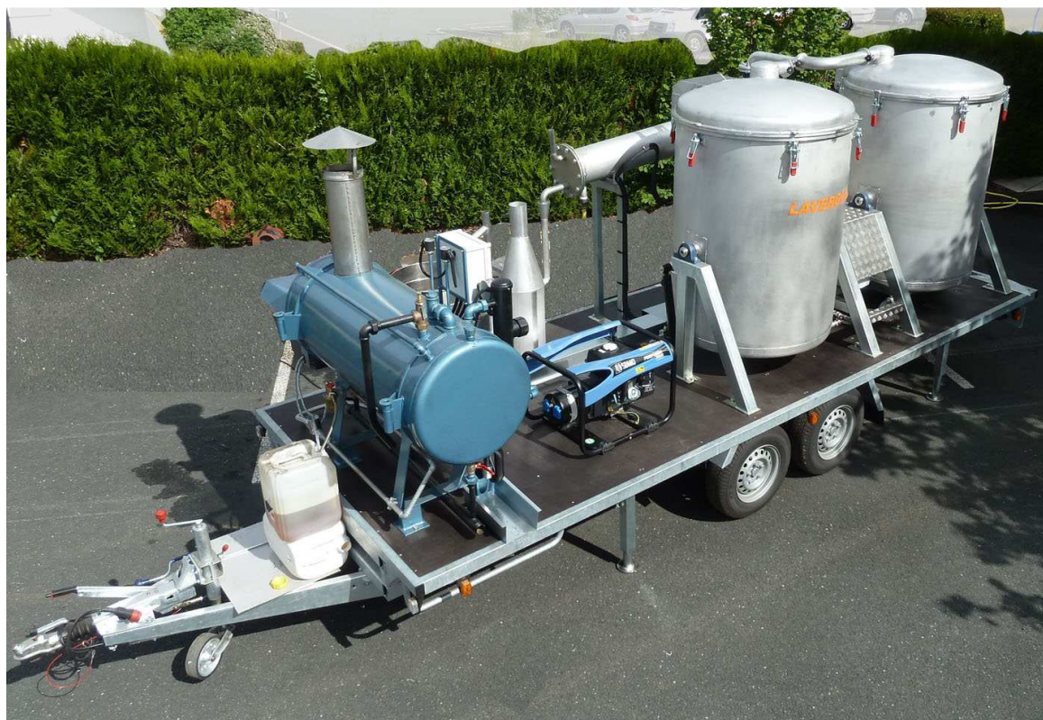
Duplex 2 cuves de 1000 litres à basculement et ouverture hydraulique
